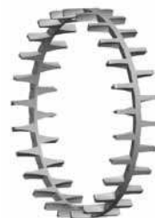
Fig. 7. Porta-rolos tipo pente usinado em peça única de bronze guiado pelos rolos
